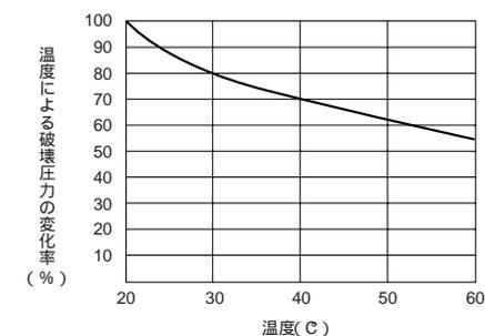
計算式 使用圧力(MPa)=20における破壊圧力×変化率×安全率(使用状況により1/3~1/4)
